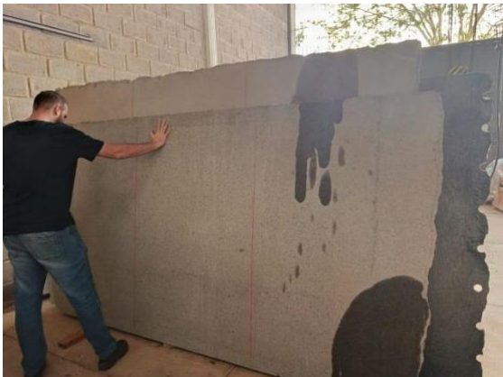
Figura 3: Chapa a ser polida dividida em três seções para polimento.
