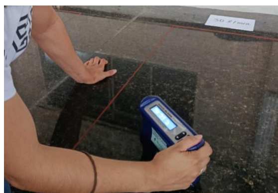
Figura 7: Mensuração do brilho com uso do equipamento glossmeter .
